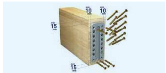
Einfräsung im Hauptträger
