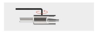
Die Schraube geringfügig mit einem Sechskantschlüssel SW2.5 lösen
