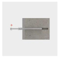
Dübel (mit Schraube) mit dem Hammer einschlagen, bis der Kragen der Kunststoffhülse bündig mit der Oberfläche des Anbauteils ist
