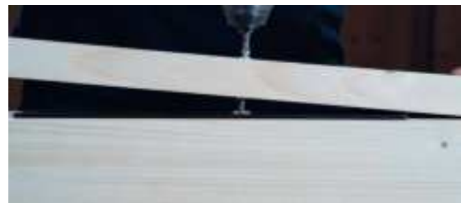
Ein vergrößertes Loch verhindert, dass sich das Holzelement beim Bohren des Metalls aus dem Grundmetall löst.
