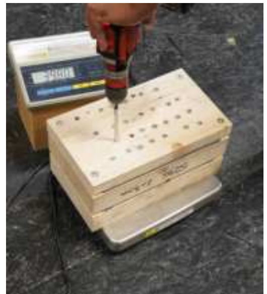
Einschraubprüfungen für selbstbohrende Stahldübel in Holz-Stahl-Anwendung mit kontrollierter Kraft.
