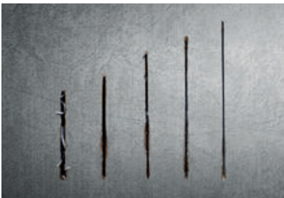
Evolution des Trennens: Gratarm mit kühlem Schnitt
