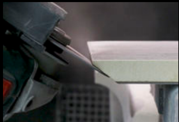
... und Anfasen mit einer Scheibe ohne Werkzeugwechsel möglich.
