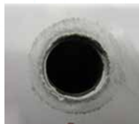
Abbildung 3: Lackierte Oberfläche nach Junker-Vibrationstest mit flachen Unterlegscheiben. Zufällige, ungleichmäßige Abnutzung der lackierten Oberfläche.
