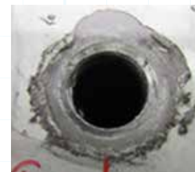
Abbildung 4: Lackierte Oberfläche nach Junker-Vibrationstest ohne Unterlegscheiben. Deutliche Entfernung des Lacks, auch Risse im Lack sind zu sehen.
