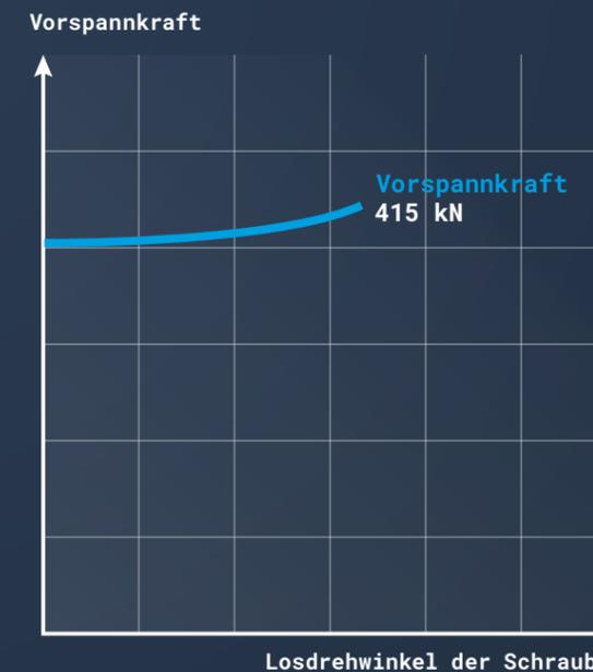
Abbildung 3: Vorspannkraft beim Lösen
