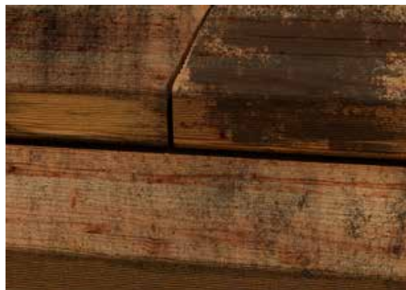
Schwarzblaue Verfärbungen durch Eisengerbstoffreaktion bei Bangkirai. Die obere rechte Bretthälfte ist mit unverdünntem fachhandelsüblichen Holzentgrauer behandelt
