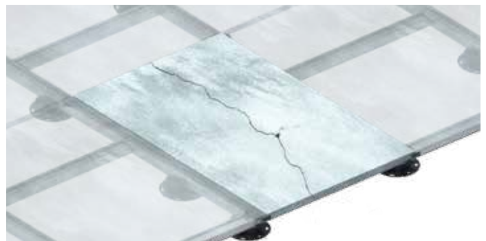
Erhöhte Bruchgefahr einzelner Platten aufgrund fehlender Stützprofile.
