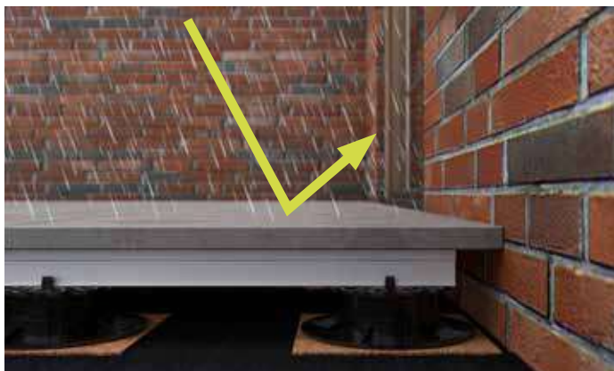
Ohne DrainTec spritzt das reflektierende Regenwasser an das Türelement oder die Fassadenverkleidung.
