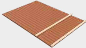
**3** Das unterste Rhombus-Profil durch die Unterkonstruktion mit den Fassadenschrauben ZK verschrauben.
