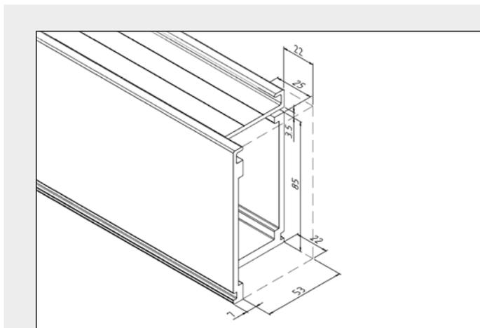
Einschnitte am Tragprofil für die Verbindung von Tragprofil und Blendprofil im Eckbereich.
