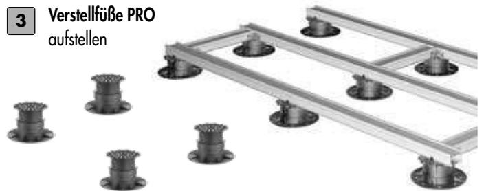
**4** **Aluminium-Systemprofil EVO** auf die Verstellfüße klicken und mit dem **Alu-Systemprofilverbinder EVO** so weit verlängern, dass die komplette Terrassenbreite abgedeckt ist.
