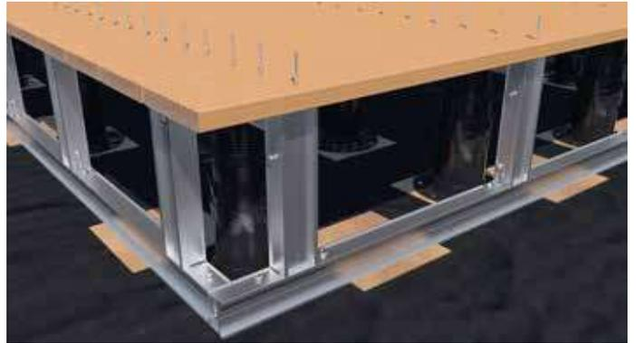
**4** Seitliche Dielen nach Wunsch mit einem 45° Schnitt versehen und in die senkrechten Profile verschrauben.
