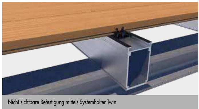
Nicht sichtbare Befestigung mittels Systemhalter Twin
