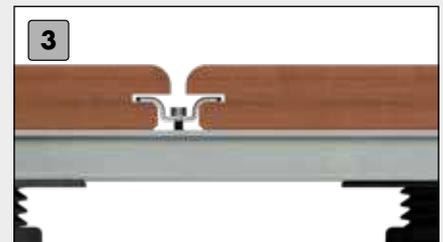
3 Weitere V-Clips einlegen und wieder leicht fixieren, dahinterliegende V-Clips können nun angezogen werden. Achten Sie hier auf die richtige Einstellung des Drehmoments!
