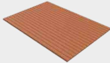
**2** Unterkonstruktion quer zu den Rhombus-Profilen gleichmäßig auslegen.
