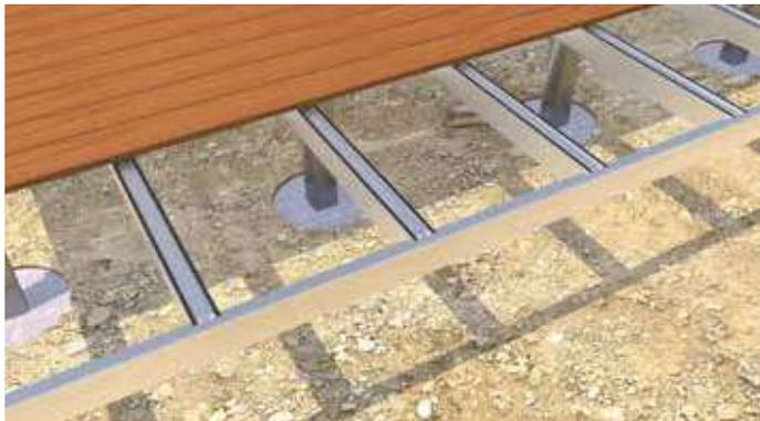
**6** Im letzten Schritt werden die Seitenblenden angebracht. Dazu werden im Vorfeld die Außenseiten des **Tragprofils HKP** mit dem **EPDM Fassadenband** beklebt. Im Anschluss werden darauf die gewünschten Holzbretter mit der **Profilbohrschraube** befestigt.
