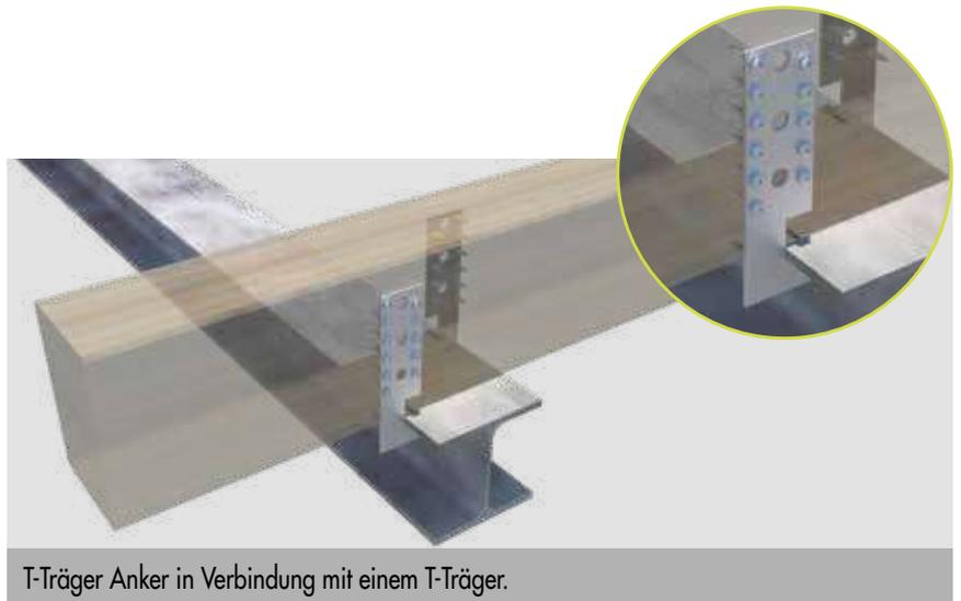
T-Träger Anker in Verbindung mit einem T-Träger.
