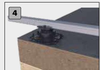
Im letzten Schritt wird das Aluminium-Profil mit der Konstruktion verbunden.
