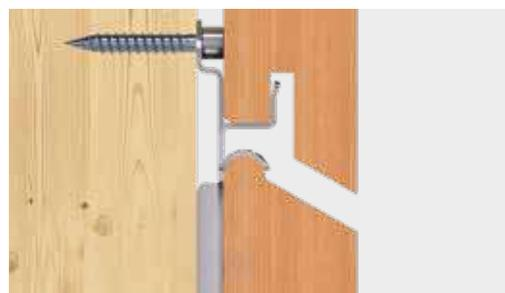
Wandanschluss mit Fassadenclip-Rhombus
