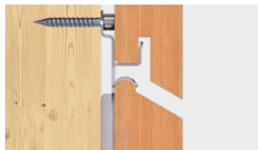
Wandanschluss mit Fassadenclip-Rhombus
