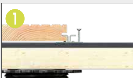
Befestigung der Schrauben in die verfügbaren Bohrungen.
